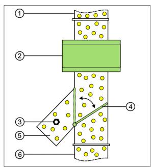
1) Inlet 4) Reject flap 2) Detection coil 5) Reject outlet 3) Metal contaminant 6) Material outlet
